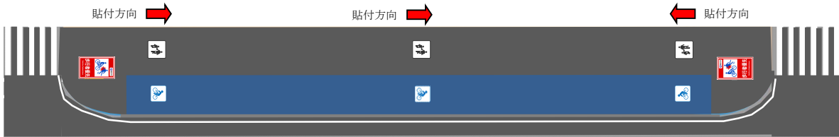
図 5-10 自転車の走行位置の法定外の明示の方法
